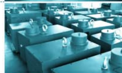
立车升降箱——丝杠升降机在机床上的典型应用：配Tr8010丝杠，提升重量250KN，成对使用，要求严格同步
