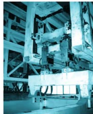
升降机在大型玻璃生产流水线上应用
