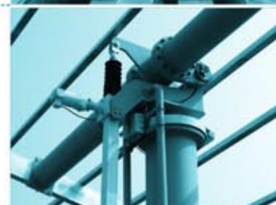
升降机在太阳能发电跟踪装置上应用（高度角、方位角跟踪）
