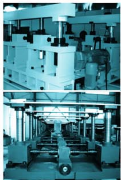
升降机在大型金属板材生产流水线上应用：举重54吨 选择4台CS250升降机+2台伞齿轮箱，配Tr8010丝杠
